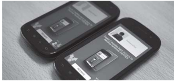
ภาพที่ 7 การใช้อุปกรณ์ที่รองรับเทคโนโลยีการสื่อสารระยะสั้นในการโอนข้อมูล
